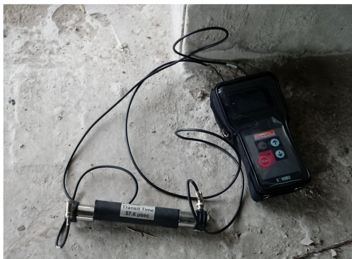
Figura 3. Equipo para ensayo de propagación de ondas. Elaboración propia.
