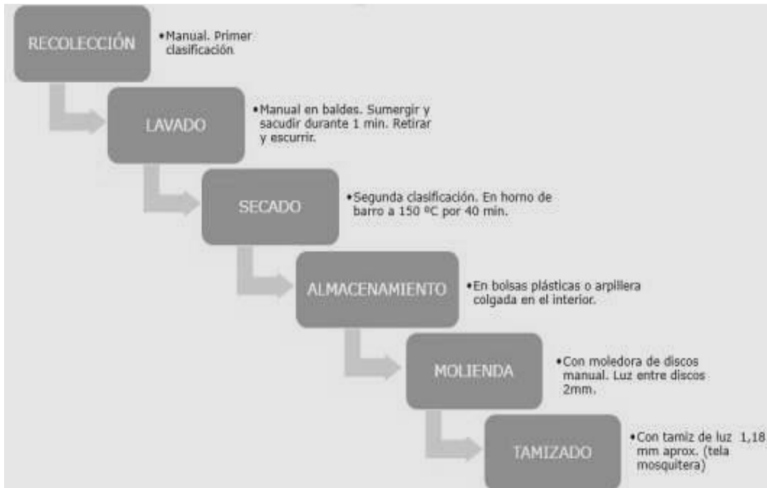
Figura 2. Diagrama de flujo del proceso estandarizado para la obtención de la harina de algarroba.
