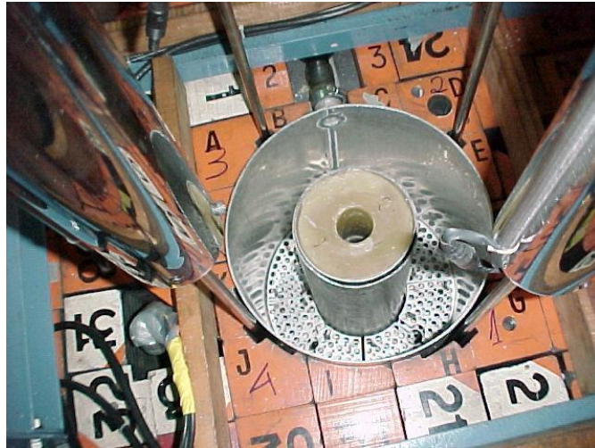
Figura 1. Núcleo del reactor donde se visualiza la disposición del sistema de barras de seguridad cuya FSE es la extinción del reactor para cumplir con la FFS control de reactividad.
