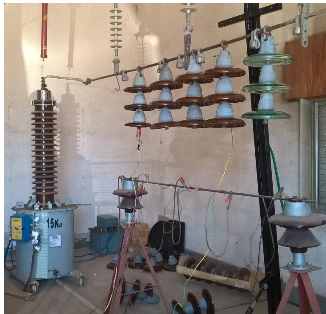
Figura 4: Equipo para ensayo de tensión aplicada en seco y bajo lluvia en instalaciones de la A.P.E. Fuente: Elaboración propia.
