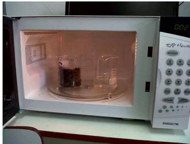
Figura 7: Horno microondas durante el ensayo de secado Fuente: elaboración propia
