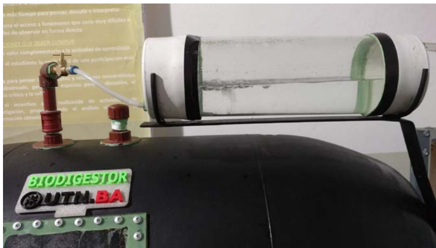
Figura 4: Conexión de salida de Biogás, con filtro de agua en solución de Bicarbonato de sodio Fuente: elaboración propia.
