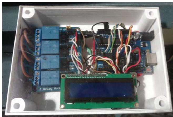
Figura 2: Conexión real de la placa Arduino. Control electrónico para el prototipo. Fuente: elaboración propia.
