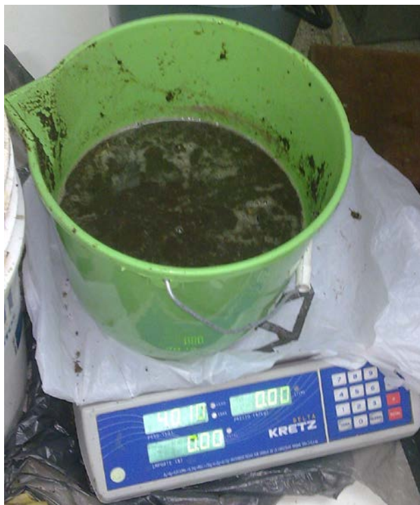
Figura 8: Preparación del sustrato, previa carga al Biodigestor Fuente: elaboración propia
