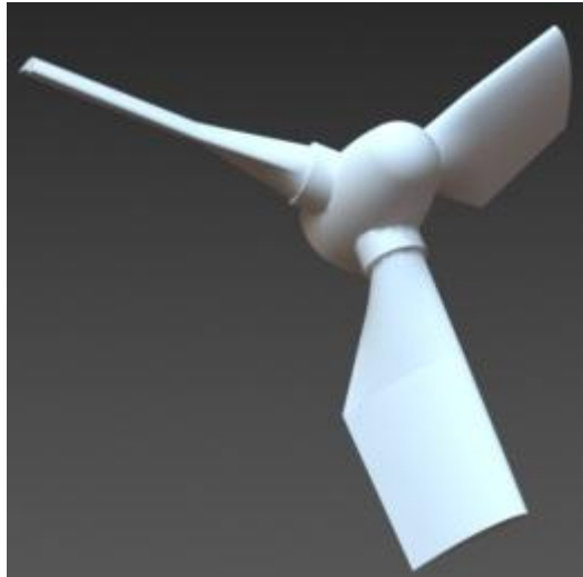
Figura 3: Imagen renderizada de la hélice del agitador mecánico. Diseño propio. Fuente: elaboración propia.
