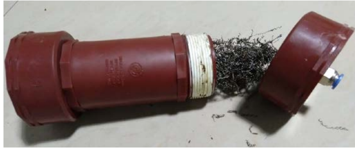
Figura 5: Filtro de H 2 S de viruta de hierro. Fuente: elaboración propia.
