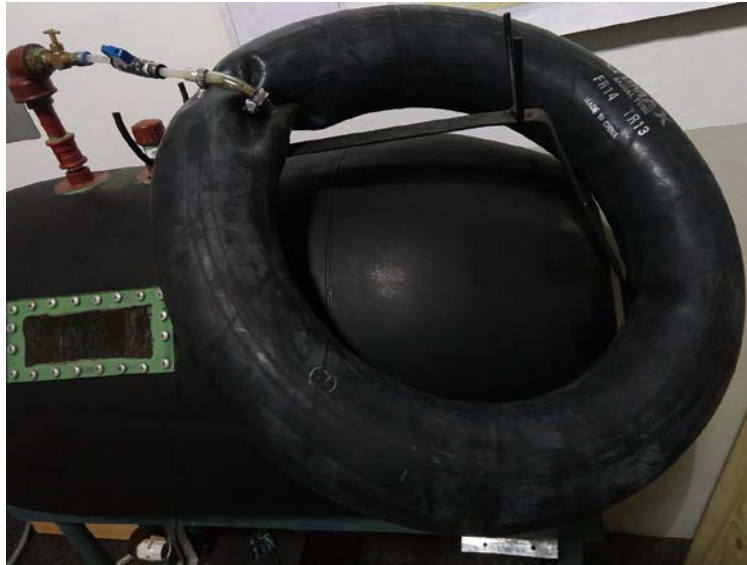
Figura 6: Cámara de auto utilizada para almacenamiento de Biogás. Fuente: elaboración propia.
