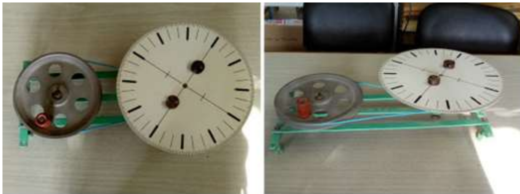
Figura 3. Dispositivo empleado para estudiar la independencia del radio de la órbita con la masa cuando la velocidad tangencial es máxima.
