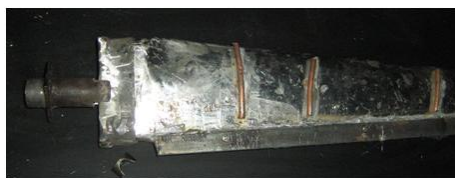
Figura 3: Molde de chapa de aspa, con refuerzos para centrifugado en torno [4].
