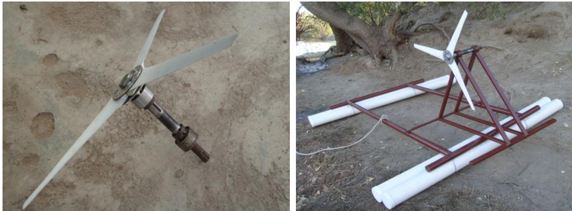
Figura 4: Rotor de tres aspas (izq.) – Rotor de turbina en sistema flotante (der.) [4].
