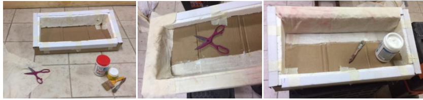
Figura 4. Refuerzos con ángulos de cartón, tela y cola.
