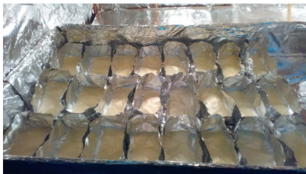
Figura 4: Las muestras para su tratamiento abiótico se colocaron dentro de la cámara de interperismo. Fuente: Elaboración propia
