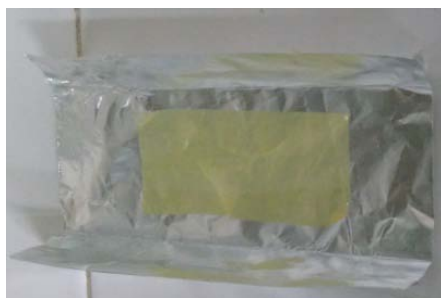
Figura 2: Muestra de polietileno extraída de una bolsa de supermercado, con las dimensiones especificadas: 3,3 cm x 7,0 cm.
