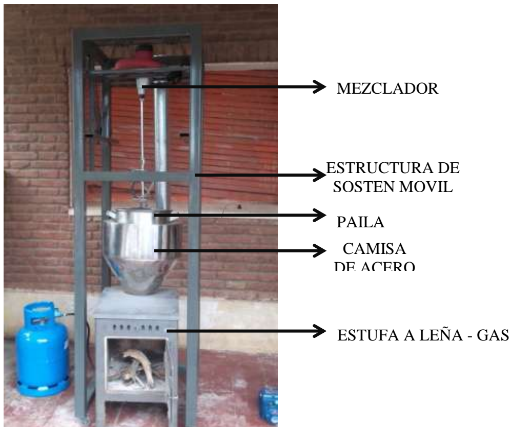
Figura 3. Concentrador de solución acuosa de algarroba/mistol/chañar Fuente: elaboración propia
