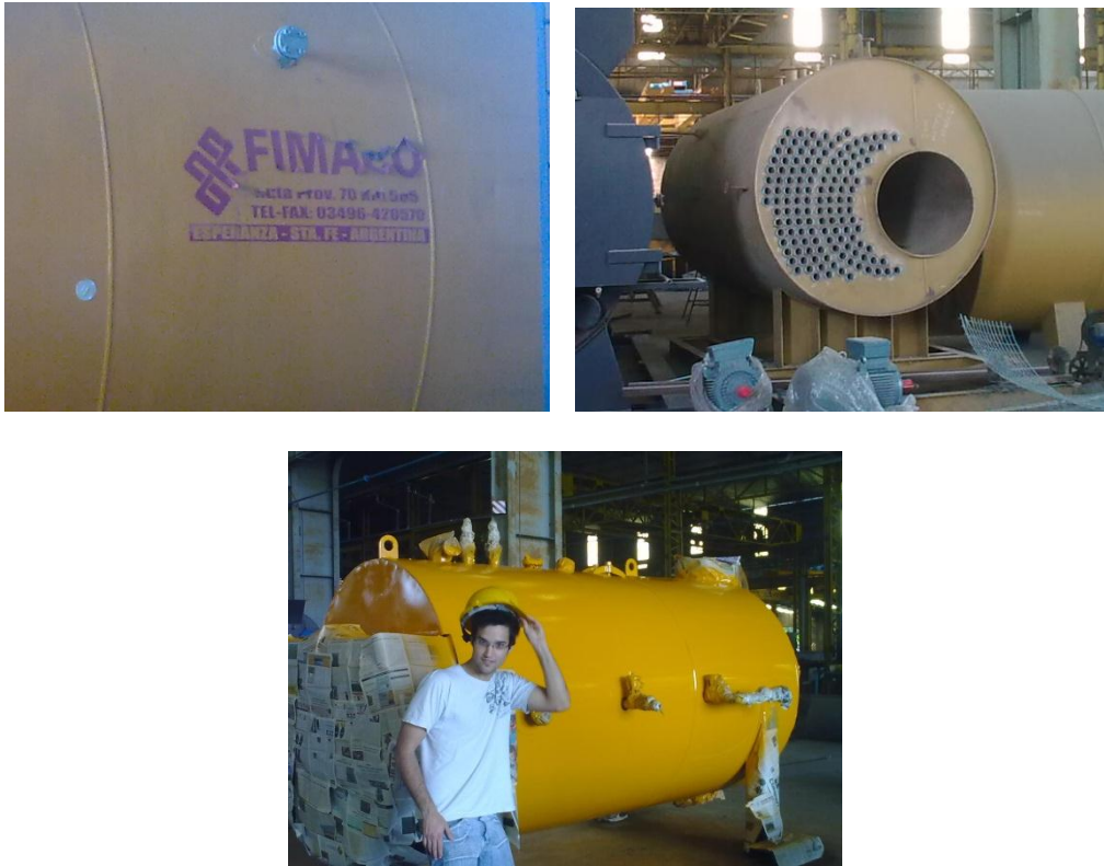
Fig. 4. Vista de parte de un tanque en chapa rolada de acero y de caldera homotubular de frente y en proceso de acabado final (fuente propia)
