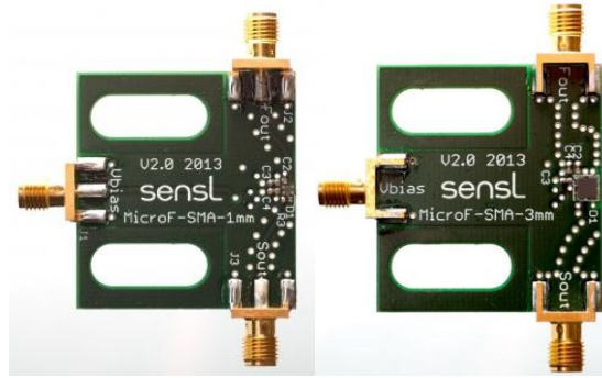
Imagen 12: Placas recibidas para conteo de fotones. MicroFC-SMA-10035 y MicroFC-SMA-30035.
