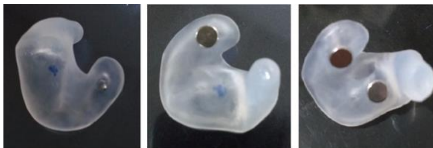
Figura 7: Montaje de los electrodos Fuente: elaboración propia
